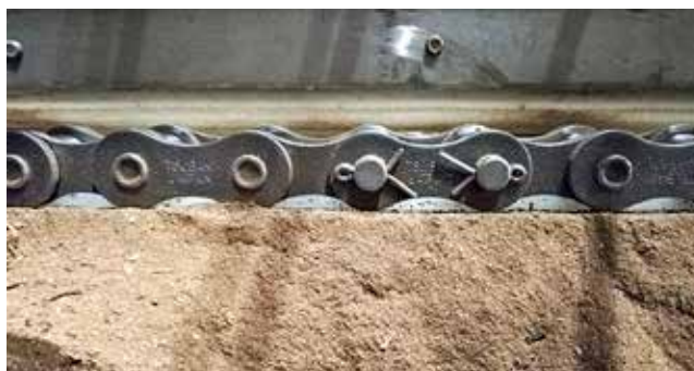
Rys. 2. Praca łańcucha w warunkach dużego zapylenia
