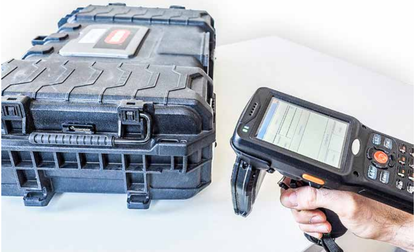
Rys. 3. Inwentaryzacja wyposażenia za pomocą kolektora danych z czytnikiem chipów RFID dalekiego zasięgu. Źródło: PWSK
