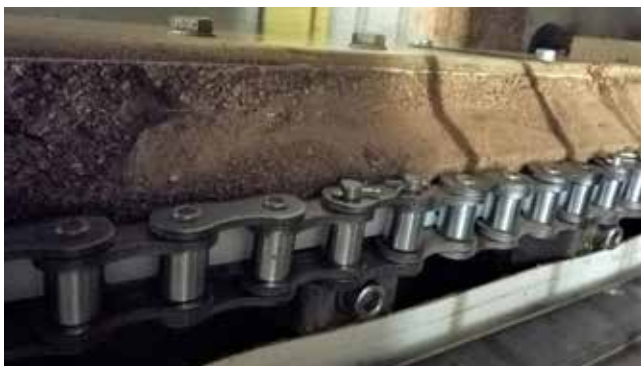
Rys. 3. Każdy zabierak mocowany na zawleczkę (łatwość demontażu)
