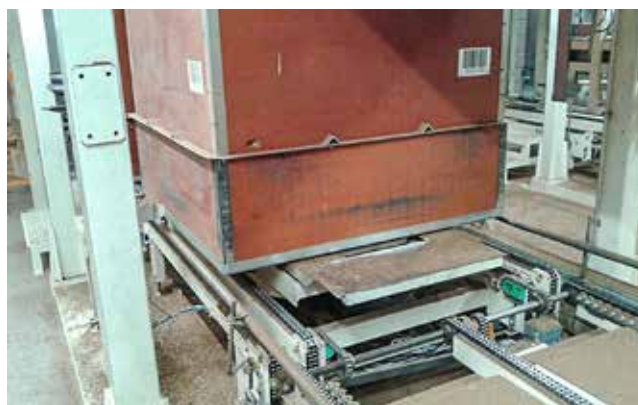
Rys. 6. Transport kontenerów z krajanek za pomocą łańcuchów
