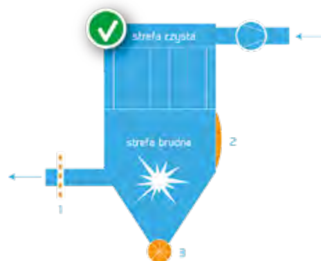
Rys. 3. Ochrona filtrów przed wybuchem – przykład rozwiązania prawidłowego
