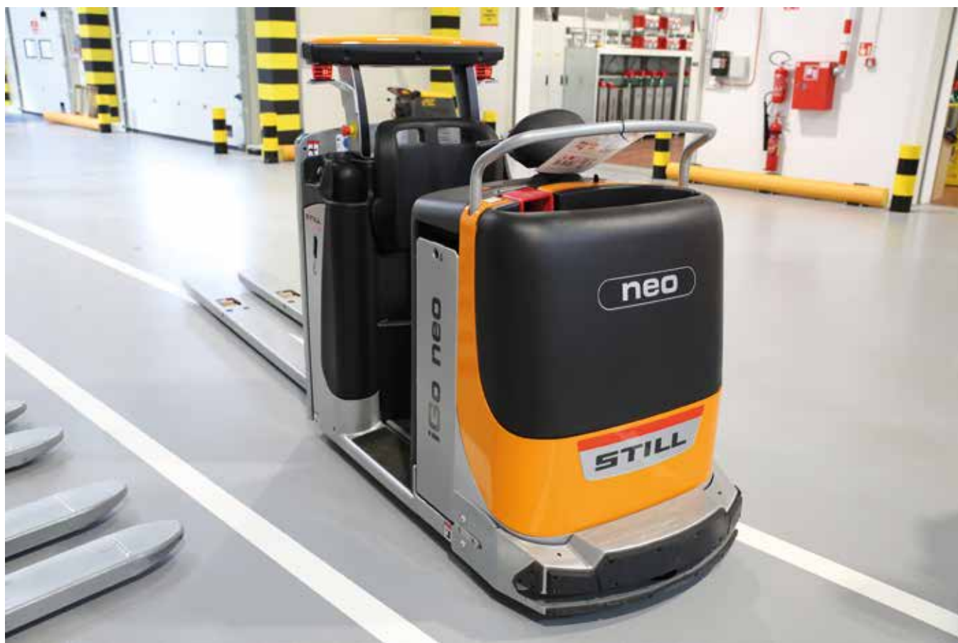
W nowym CD Biedronki testowane są autonomiczne wózki STILL iGo neo CX 20 (fot. JMP)
