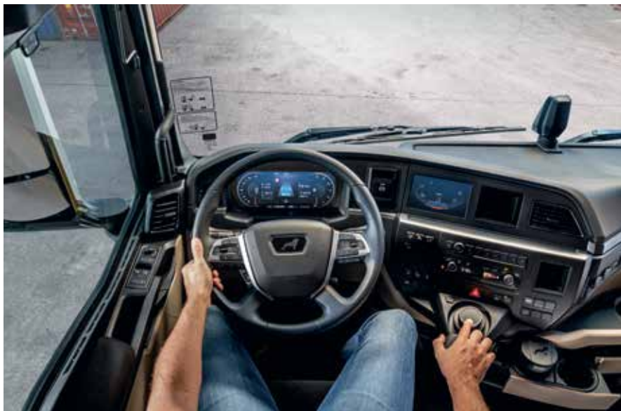
Wyświetlacze są nieco oddalone od kierowcy, co ułatwia akomodację przy przenoszeniu wzroku z przyrządów na drogę, zwłaszcza starszym kierowcom. Pokrętła i przełączniki są łatwo wyczuwalne, można je obsługiwać także w rękawiczkach. Ważne lub często używane funkcje są zawsze w tych samych miejscach
