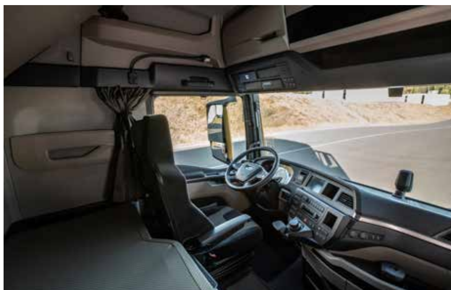
Projektanci uwzględnili swobodę poruszania się w kabinie: strefa pośrodku może być dowolnie wykorzystana, gdyż nie ma tam konsoli sterowania automatyczną skrzynią biegów (teraz w dźwignie pod kierownicą) ani hamulca postojowego (elektryczny na tablicy rozdzielczej). Do obsługi Mediasystemu służy SmartSelect, pokrętło-przycisk. Dzięki temu wzrok pozostaje na poziomie drogi i przyrządów
