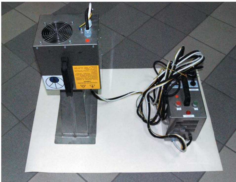
Fot. 7. Osuszacz mikrofalowy Źródło: C. Magott [4]
